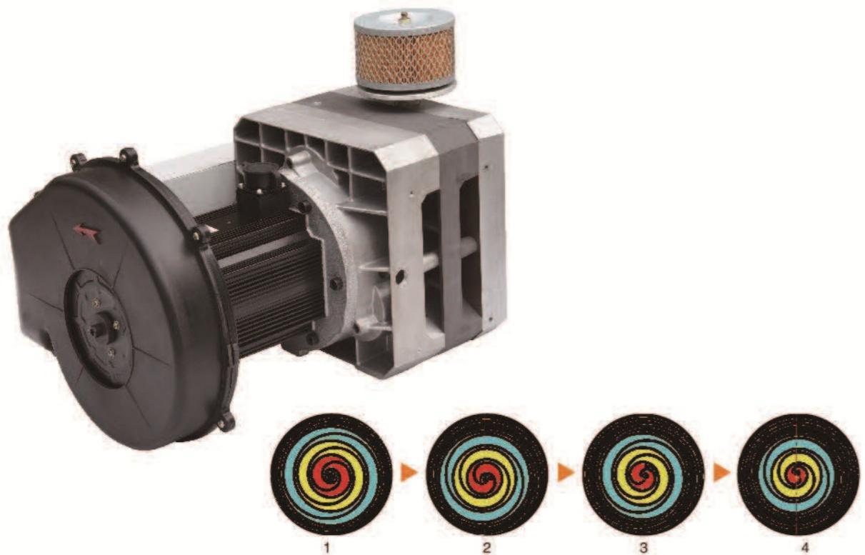
动涡旋盘按照1-4的顺序运动，吸入的空气在动涡旋盘和静涡旋盘咬合形成的月牙形压缩腔内被逐步缩小体积进行压缩，最后从静涡旋盘中心部位的排气口排出。
